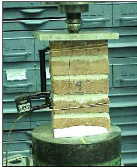
شکل ت-۲-۱ آزمایش تنش فشاری مصالح بر روی نمونه
