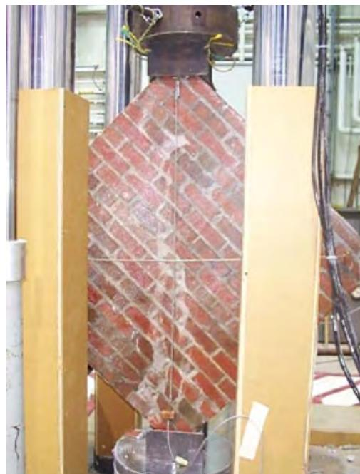
شکل ت ۲-۷ آزمایش فشاری قطری
